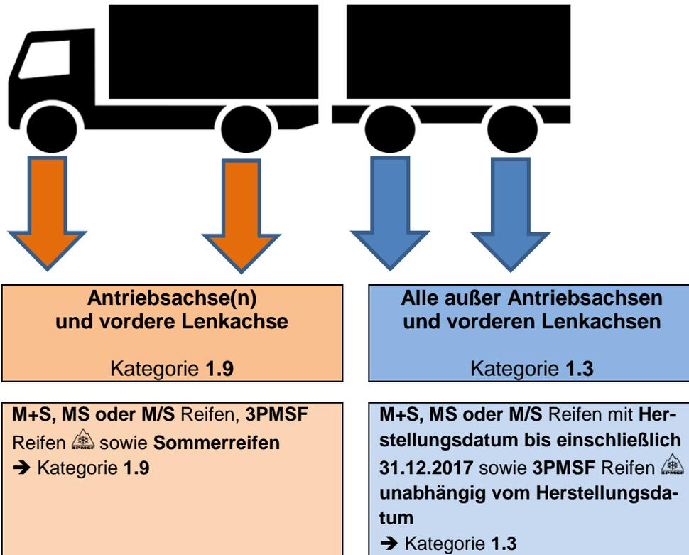
Beispielhaftes Schaubild eines Sattelzuges mit Heckantrieb
