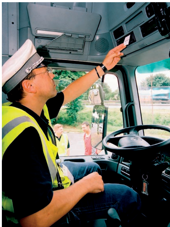
Auslesen des Digitalen-Tachographen
