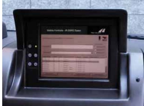
Anzeige im Mautkontrollfahrzeug
