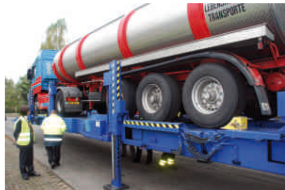
Mobile Lkw-Hebebühne bei einer gemeinsamen Kontrolle
