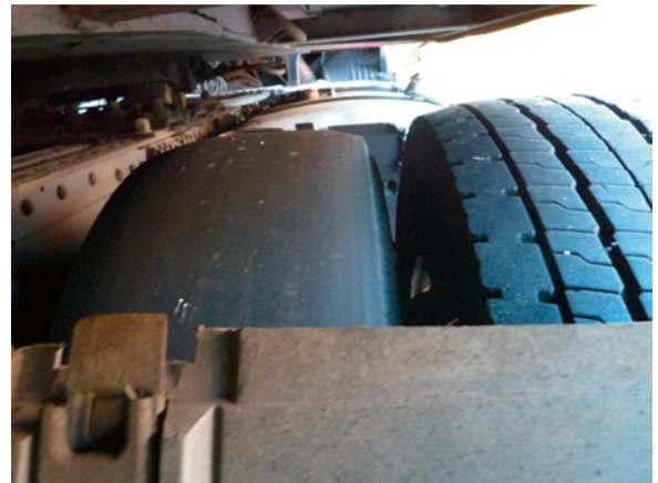
Abgefahrener Reifen ohne Profiltiefe, die Karkasse des Reifens ist bereits sichtbar. Die Weiterfahrt wurde bis zur Behebung des gefährlichen Mangels untersagt.
