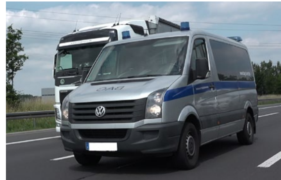
Kontrollfahrzeug mit Sensorik in der Vorbeifahrt
