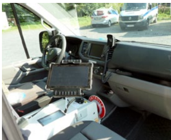
Innenraum des Kontrollfahrzeugs, Tablet zur Darstellung der Informationen für den Beifahrer
